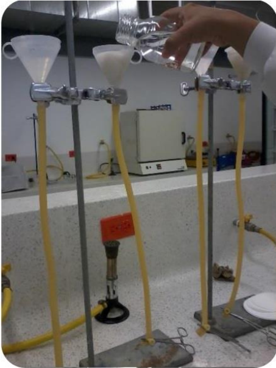
Figura 3. Preparación de la muestra mediante el método embudo de Baermann. Fuente autores.
